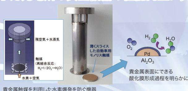
原子力発電所の水素爆発防止のため、電源不要で水素を無害化できる機器が注目されています。その最重要部品である触媒に関して、水素と酸素の再結合反応においては、いったん貴金属表面に酸化膜が形成される過程が重要であることを放射光により初めて明らかにしました。
