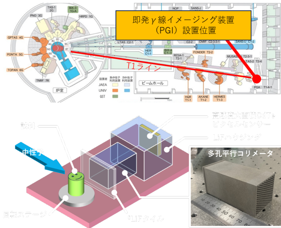
図3-21 PGI実験ポート設置予定位置と即発ガンマ( \gamma )線イメージングシステム
